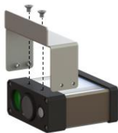
Figura 29: Desmontando el sensor Laser.
