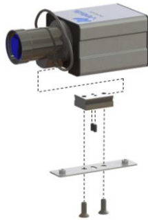
Figura 8: Desmontar el articulador de la tapa de apoyo.
