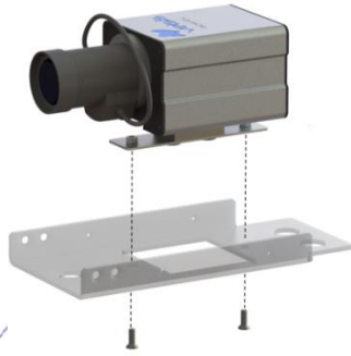
Figura 7: Retirar la cámara del soporte acrílico.
