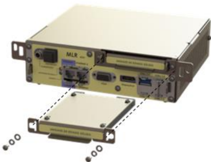
Figura 19: Retirar el HD del módulo relevante
